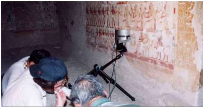
図35 壁画の測定（X線回折装置）
