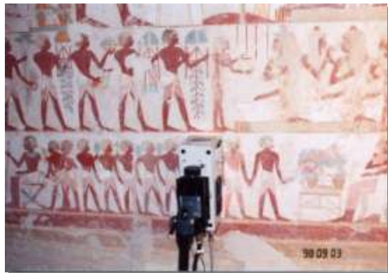
図34 壁画の測定（蛍光X線分析装置）
